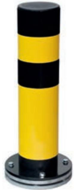
Basiert technisch auf dem nachgebenden Rammschutz-Poller SWING. Zusätzlich drehbar durch eine massive Stahl-Bodenplatte mit sechs eingelassenen Kugellagern.
