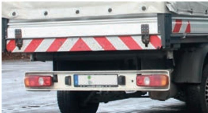
Fahrzeuge, die beim Bau, der Instandhaltung, der Müllabfuhr oder der Reinigung von Straßen eingesetzt werden, müssen durch rot-weiß reflektierende Warnmarkierung, Folie Typ 2 (DIN 30 710) gekennzeichnet sein (§ 35 StVO, Abs. 6).
